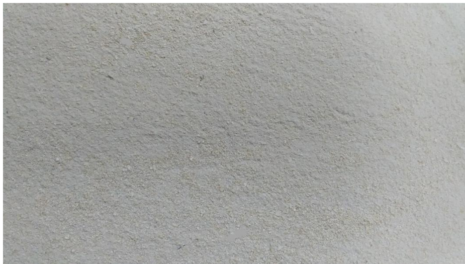
الشكل (3) السطح الماز (قشور البيض) الناتج من عملية المعالجة.
